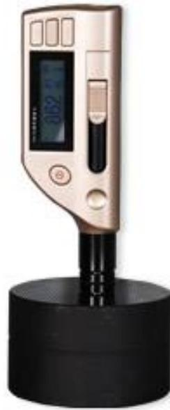
TIME5100 里氏硬度计是一种新型的袖珍式一体化硬度测试仪器，主要适用于测试金属材料的硬度，具有测试精度高、体积小、操作容易、携带方便，测量范围宽的特点，它是以里氏硬度为原理，测出里氏（HL）硬度值经过程序自动转换成布氏，洛氏，维氏，肖氏等硬度值，还可以配置各种测试配件，来满足于各种测试条件和环境，主要适用于金属材料的快速硬度测试，特别适宜对大型零部件及不可拆卸部件的现场硬度测试。
